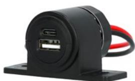
Prise en saillie Carpoint 12/24V avec une connexion USB-A et USB-C de 5V 2,4A. Pour charger simultanément jusqu'à deux appareils comme un smartphone, un GPS, une tablette ou un ordinateur portable. Montage par vis avec un entraxe de 40 mm. Câble + et - à code couleur d'une longueur de 15 cm et connexion par cosse de câble.
