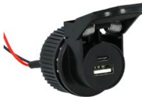
Prise encastrable Carpoint 12/24V toutes saisons avec une connexion USB-A et USB-C de 5V 2,4A. Pour charger simultanément jusqu'à deux appareils comme un smartphone, un GPS, une tablette ou un ordinateur portable. Un entraxe de 45 mm. Câble + et - à code couleur d'une longueur de 15 cm et connexion par cosse de câble. Avec capuchon de protection anti-poussière pour les ports USB.
